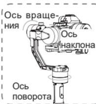
**Режим блокировки:** блокирует положение всех трех осей и фиксирует камеру для съемки в нужном направлении. Для ручного управления осью наклона сдвиньте джойстик вверх или вниз, для управления осью панорамирования — влево или вправо.
