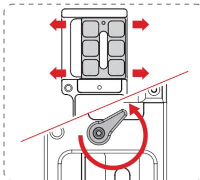
Ослабьте винт крепления камеры снизу пластины крепления так, чтобы ее можно было двигать вперед и назад.
