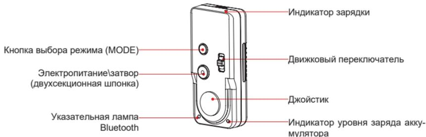
**Питание и видеосъемка (двухступенчатая кнопка спуска затвора)**
