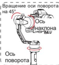
**Режим POV:** камера следует за движением стабилизатора и может поворачиваться влево или вправо до 45° и выполнять панорамирование на 360°.
