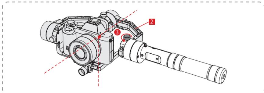
Ослабьте барашковый й3 винт. **3** Отрегулируйте ось поворота до тех пор, пока камера не остановится, удерживая вертикальную лапу **2** ровно, при повороте вправо/влево. Завершите корректировку баланса, затянув барашковый винт.
