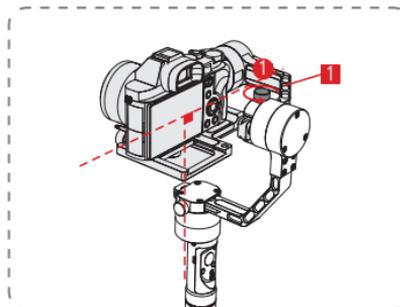
Ослабьте барашковый **1** винт. Отрегулируйте ось вращения до тех пор, пока камера не остановится, удерживая горизонтальную лапу **1** ровно. Завершите этот шаг, затянув барашковый винт.
