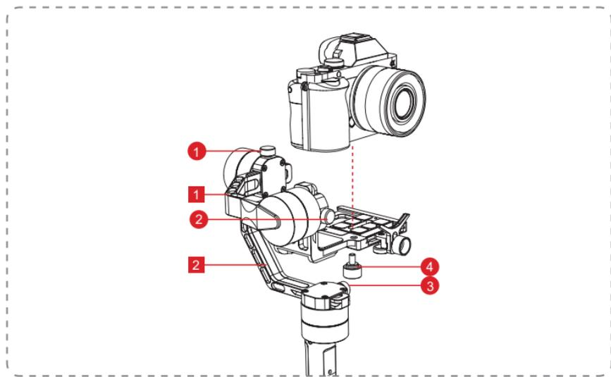
Закрепите камеру параллельно пластине крепления, совместив отверстие с резьбой 1/4" в нижней части камеры с пустым гнездом пластины крепления. Переместите камеру как можно ближе к мотору наклона ④ и затяните винт крепления камеры, чтобы зафиксировать положение камеры.
