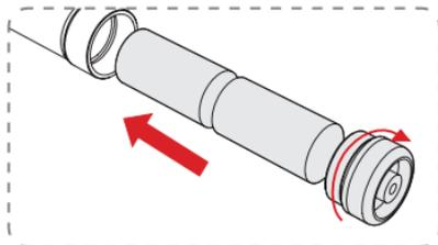
1. Поверните, чтобы открутить торцевую крышку, после чего установите два литиево-ионных аккумулятора 26500. Обязательно закрутите торцевую крышку после установки аккумулятора, иначе стабилизатор не включится.
