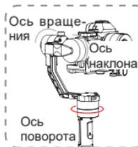
**Режим отслеживаемого панорамирования:** камера ведет съемку в режиме панорамирования, следуя за движением стабилизатора влево или вправо; положение осей наклона и поворота при этом блокируется. Для ручного управления осью наклона сдвиньте джойстик вверх или вниз.
