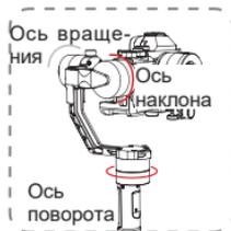
**Режим слежения:** камера следует за движением стабилизатора, для перемещения камеры используются оси панорамирования и наклона. Для ручного управления осью поворота сдвиньте джойстик влево или вправо.
